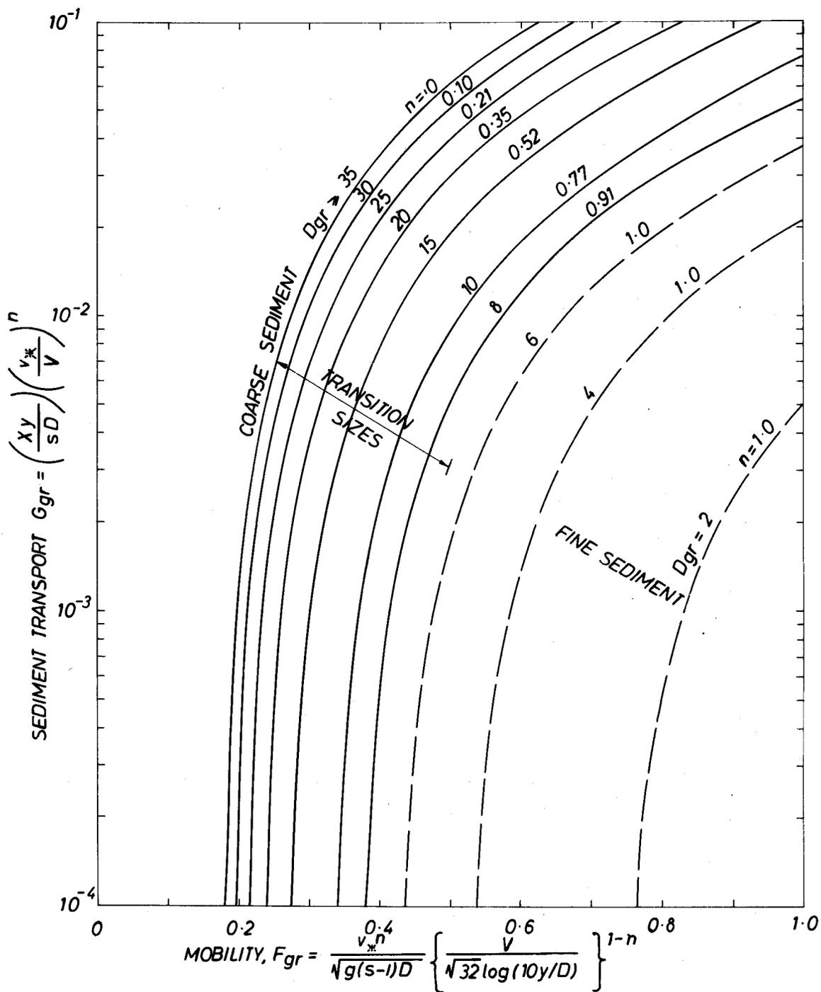
FIG 9. TRANSPORT FUNCTION =  $G_{gr}, F_{gr}$  FOR ISO- $D_{gr}$
