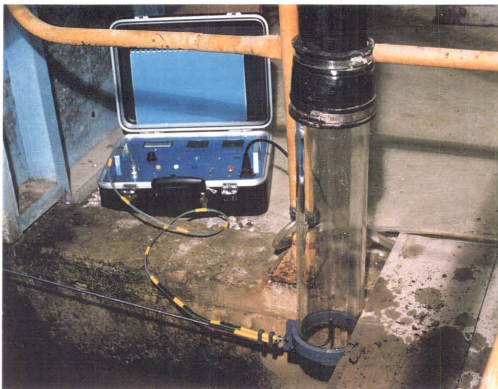
Plate 9 Air void meter
